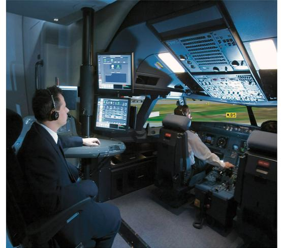
Cabina de simulación de vuelo de un Airbus A320
